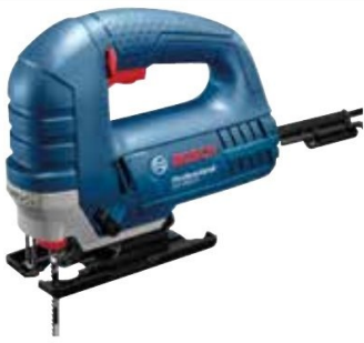
SIERRA DE CALAR GST 8000 E BOSCH 710 W. Profundidad de corte hasta 80 mm. Movimiento pendular de 4 escalones.
